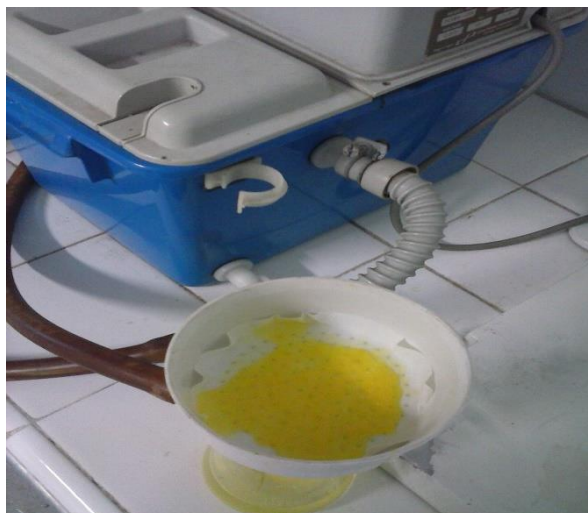
Figura 3 - Filtración utilizando bomba de vacío.
