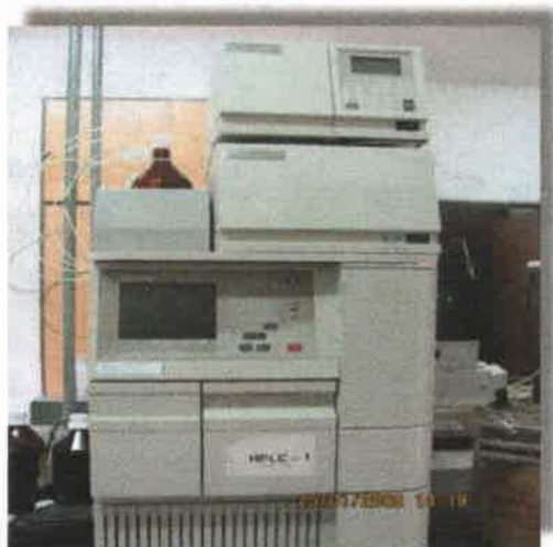
Figura 15. Equipo de HPLC-DAD acoplado a un detector de fluorescencia.
