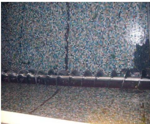
Figura10: Sinfín del lagar de descarga de uva.
