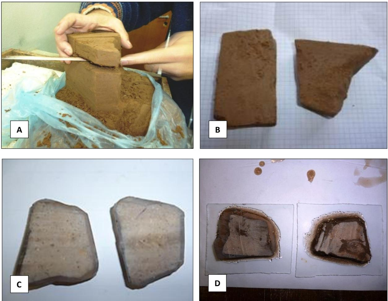
**Figura 3.** Secciones delgadas. **A-** Dama en laboratorio. **B-** Pastilla del suelo cementado. **C-** Pastillas de suelo impregnada con resina. **D-** Pastillas montadas sobre portaobjeto.
