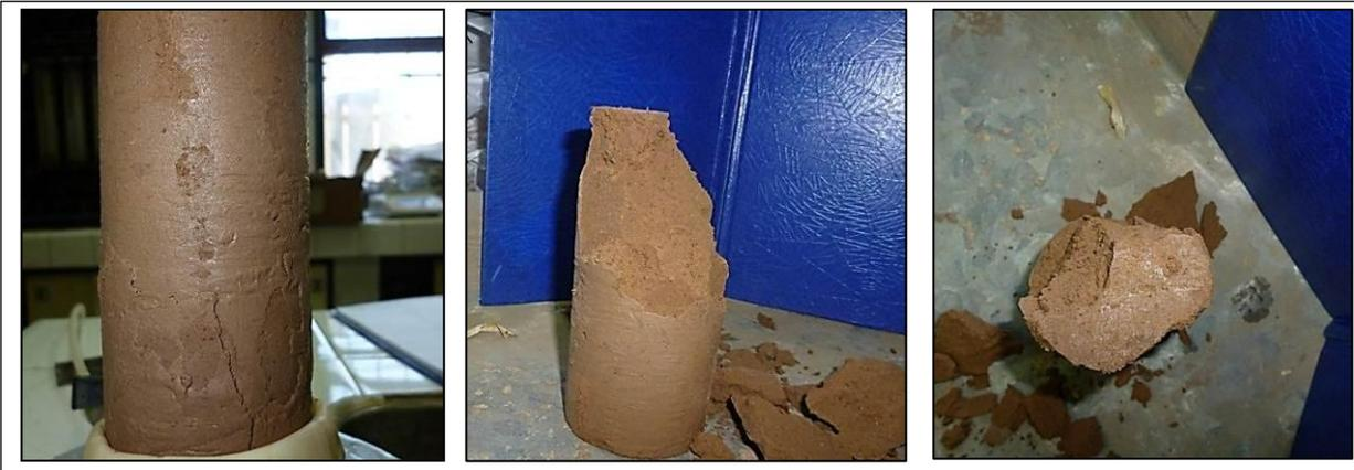
**Figura 50.** Probeta 3 posterior a la rotura. Distintos ángulos de observación de los planos de rotura.
