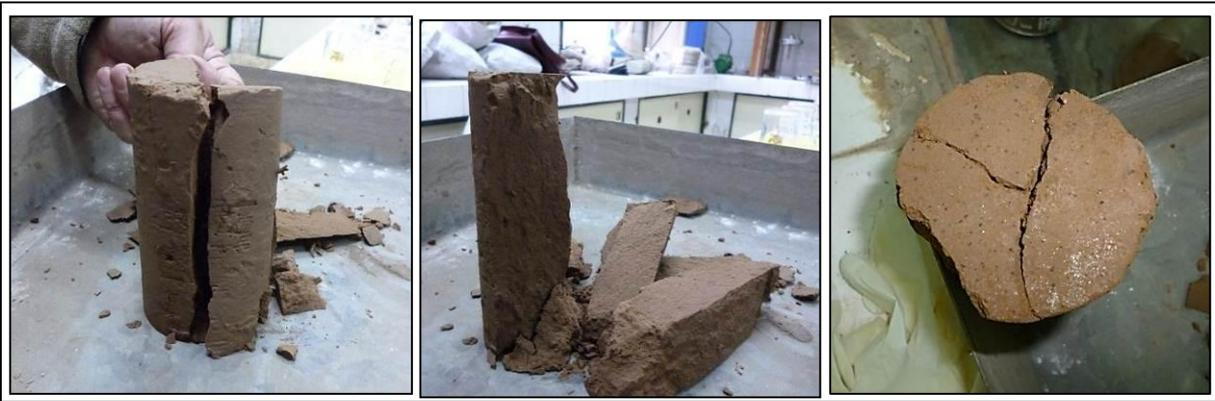
**Figura 49.** Probeta 2 posterior a la rotura. Distintos ángulos de observación de los planos de rotura.
