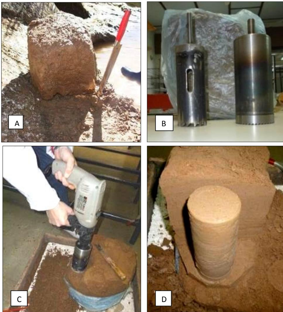
**Figura 2.** Tallado de probetas para ensayo triaxial. **A-** Dama obtenida in situ. **B-** Herramienta perforadora tipo broca. **C-** Herramienta perforadora adaptada a taladro. Corte de probeta. **D-** Probeta.
