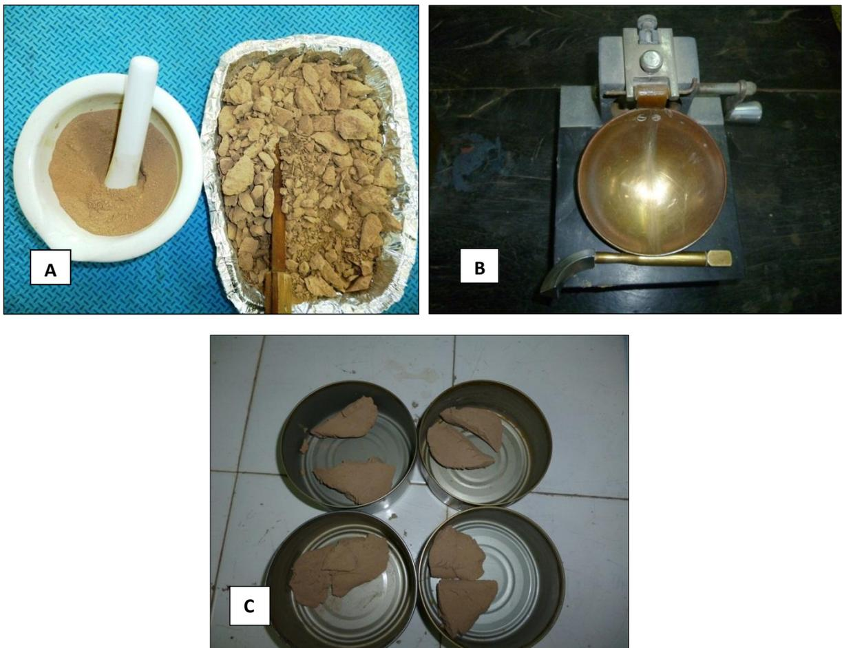
**Figura 4.** Límites de consistencia. **A-** Material pasado por mortero. **B-** Dispositivo de Casagrande para la determinación de límites de Atterberg. **C-** Muestras secas utilizadas para la determinación del contenido de humedad.
