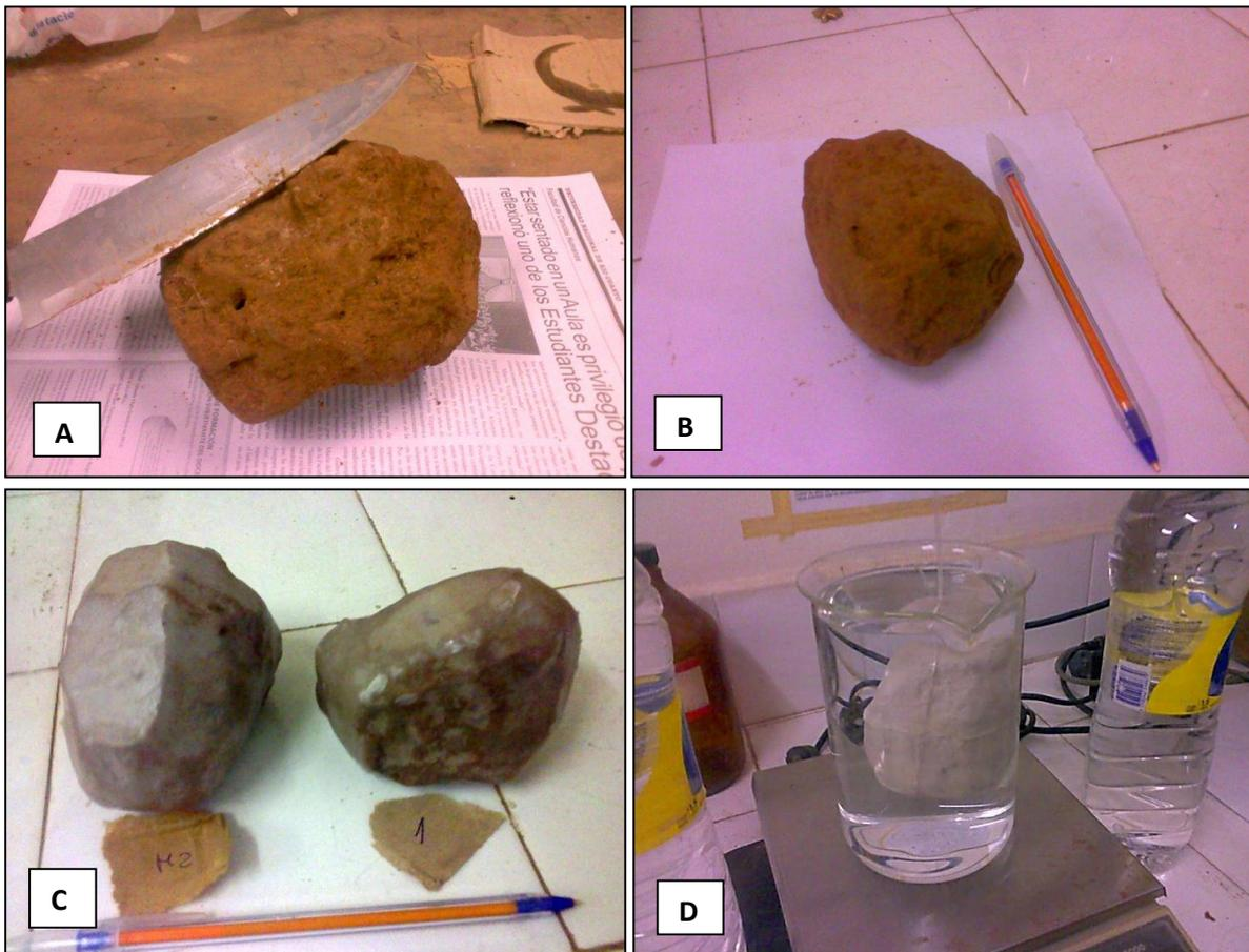
Figura 5. Determinación del Peso específico aparente. A- Muestra en laboratorio. B- Terrón modelado.
