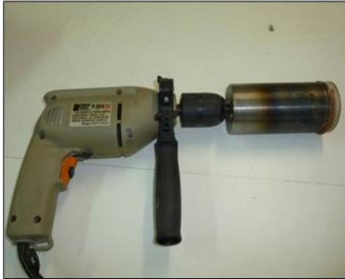
Figura 42. Herramienta tipo broca, adaptada a taladro, cortadora de material cementado . /cohesivo.
