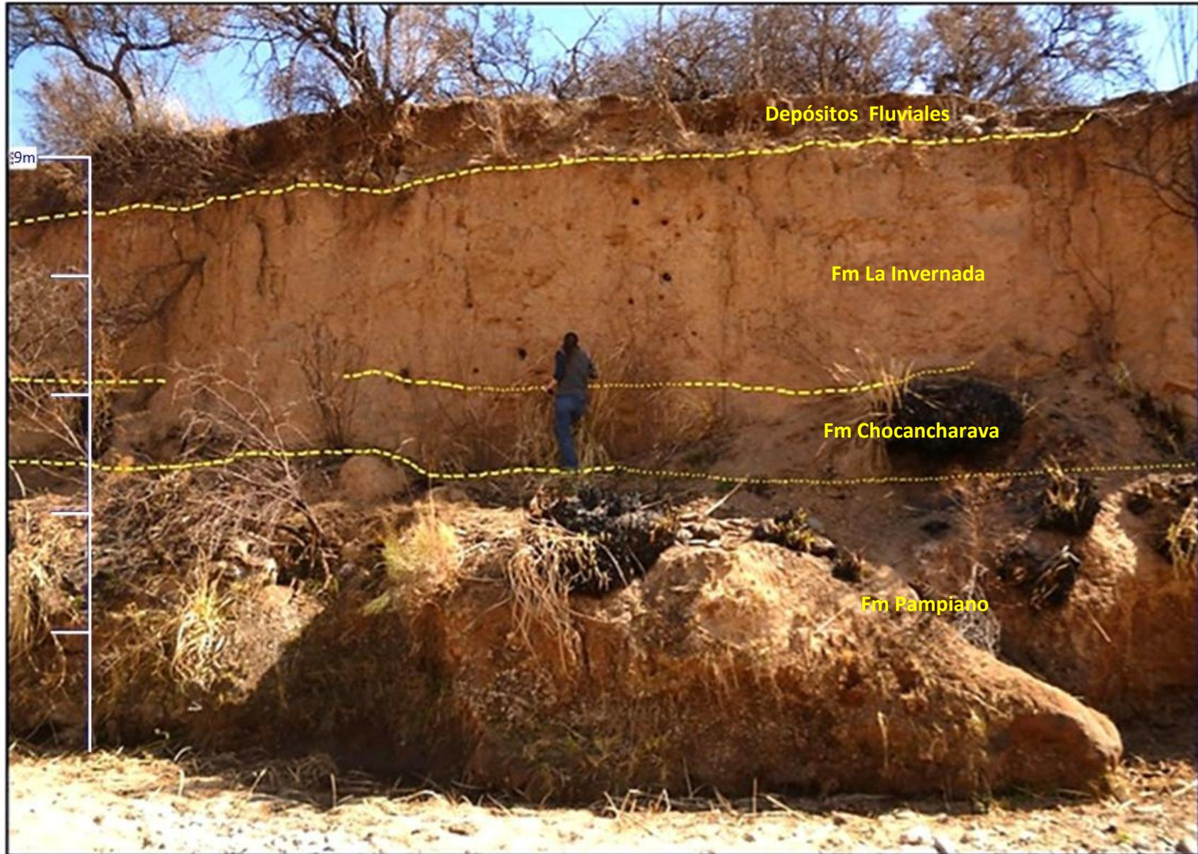
Figura 23: Perfil Estratigráfico LC2. Localizado aproximadamente 500 m aguas arriba del puente de la ruta Provincial N° 23. Sector muestreo para ensayo triaxial.
