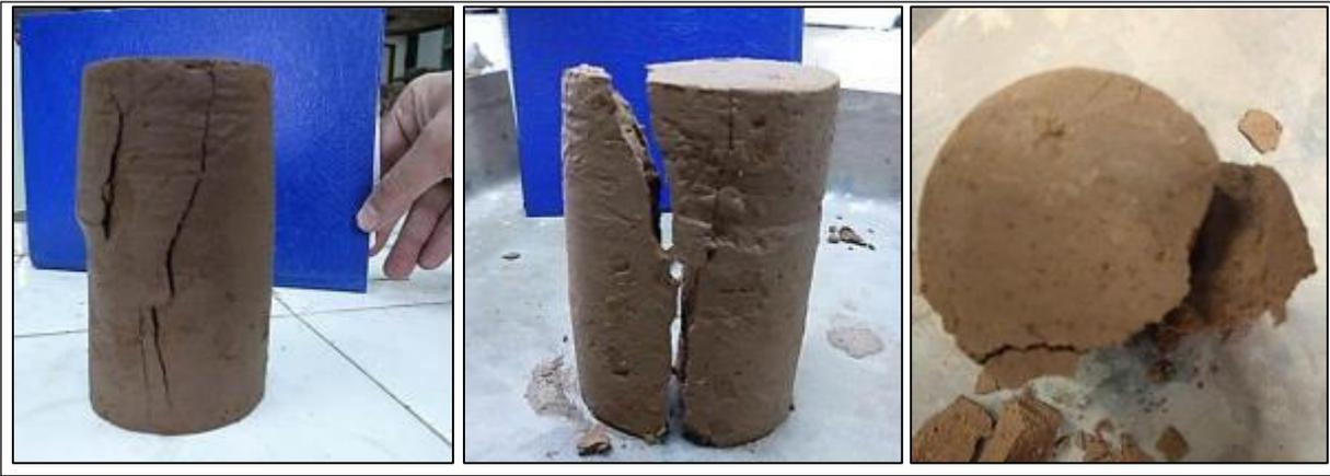
**Figura 48.** Probeta 1 posterior a la rotura. Distintos ángulos de observación de los planos de rotura.
