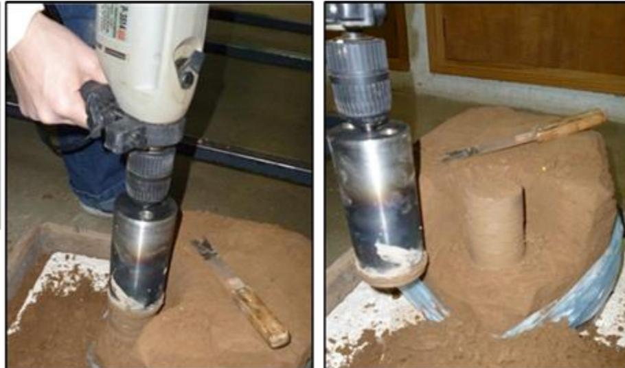
Figura 43. Distintas etapas de cortado de la primera probeta.
