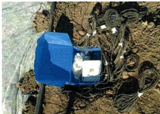
Imagen 20. Equipo data loggers para la medición de la temperatura del aire.
