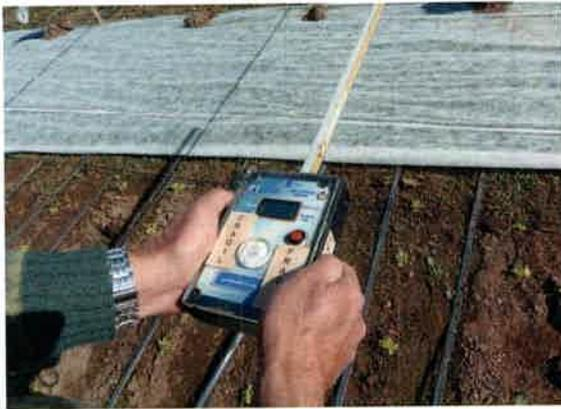
Imagen 15. Barra de radiación BAR-RAD 100 con sensores LICOR.
