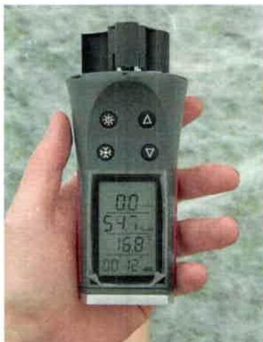
Imagen 19. Termo- higo anemómetro digital marca Skywatch (Atmos) para la medición de H° relativa del aire.
