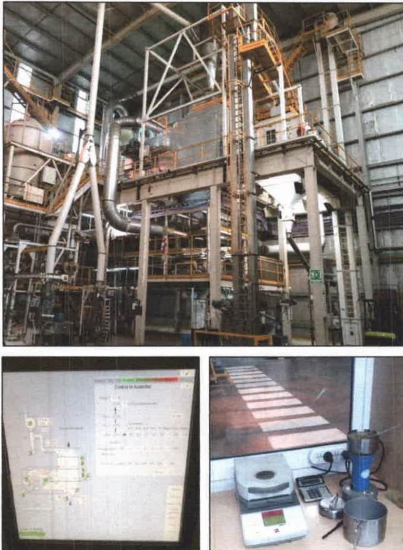
Figura 5.9. Secadora, detalle del visor de la Secadora y Termobalanza.
