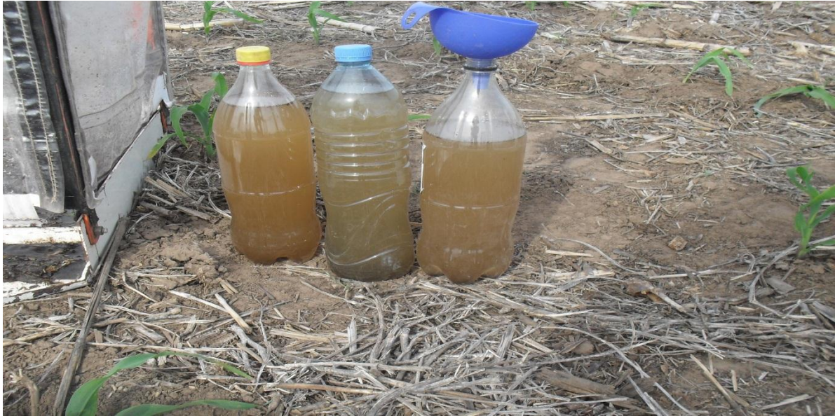
Foto 5: Lámina colectada producto de escurrimiento en el tratamiento de 60 mm/h. Nótese que el volumen escurrido correspondió al volúmen de tres botellas aproximadamente.
