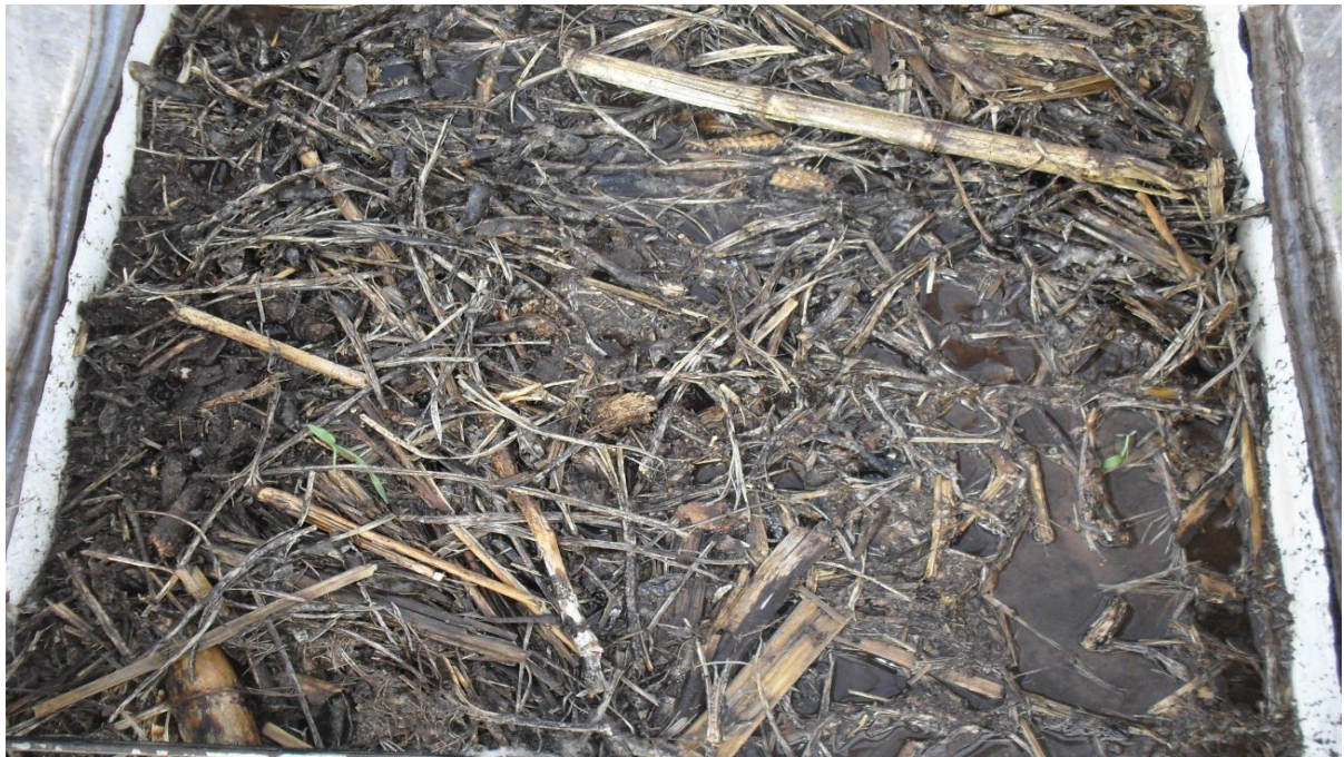
Foto 4: Vista de la superficie del suelo al finalizar la simulación de precipitación de intensidad de 60 mm/h. Nótese el sello superficial en el sector de abajo a la derecha de la imagen.
