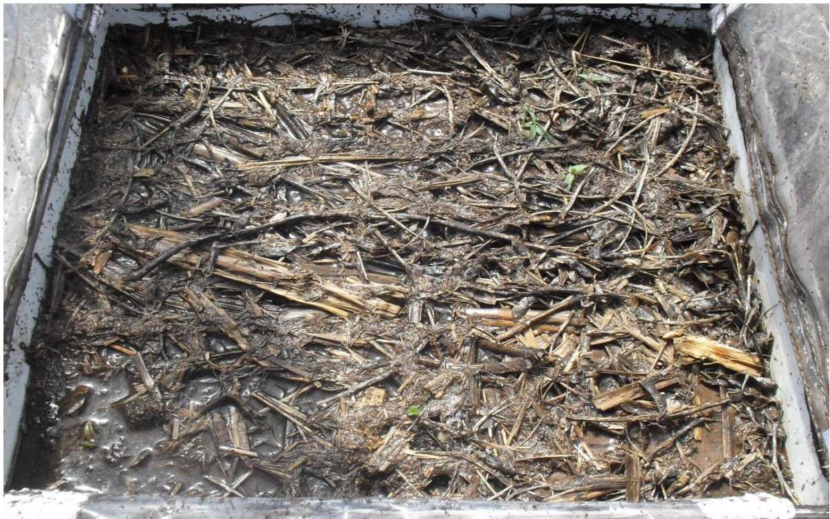
Foto 6: Vista de la superficie del suelo al finalizar la simulación de precipitación de intensidad de 100 mm/h. Nótese el encharcamiento superficial.
