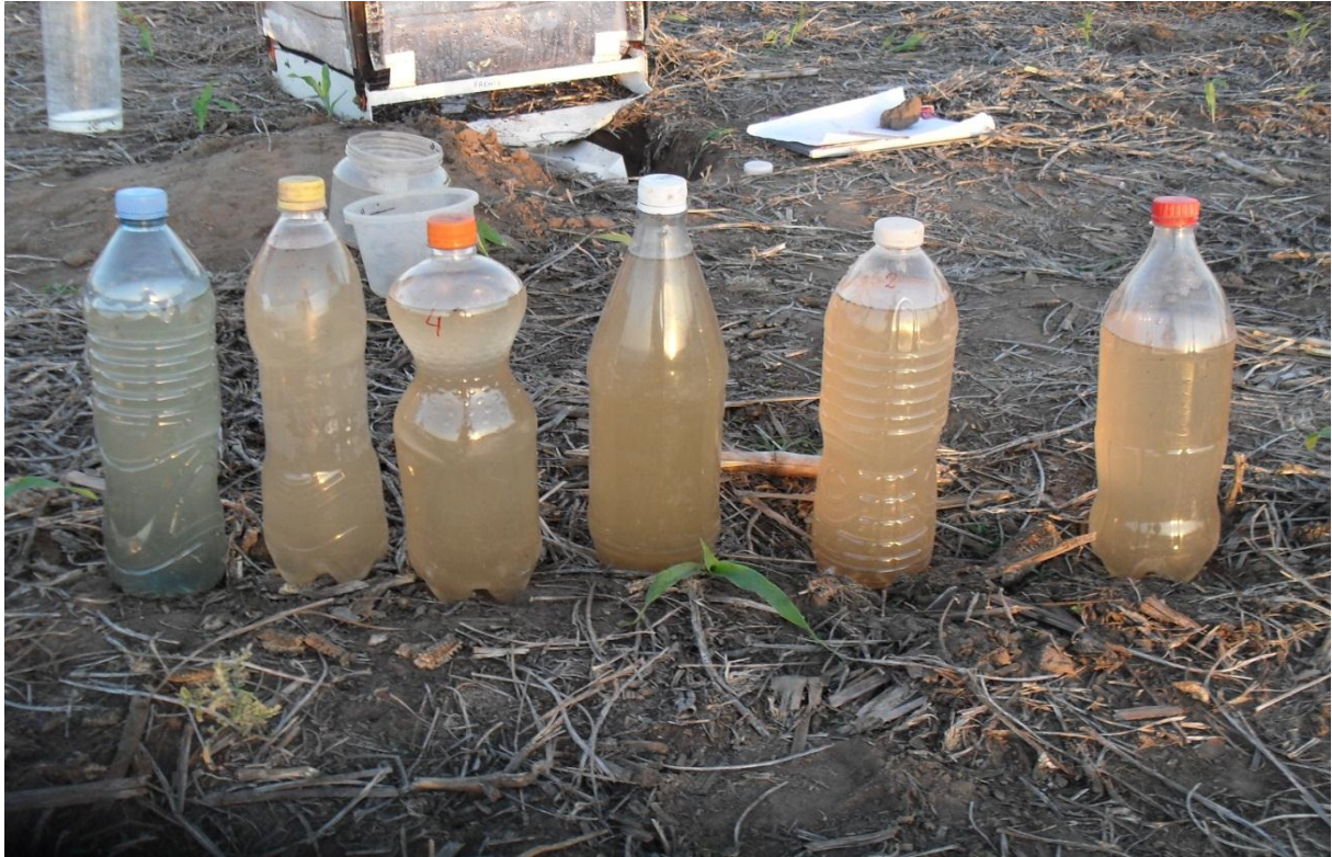
Foto 7: Lámina colectada producto de escurrimiento en tratamiento de 100 mm/h. El número de botellas indica el volúmen total escurrido que duplica al obtenido con intensidad de 60 mm/hora.
