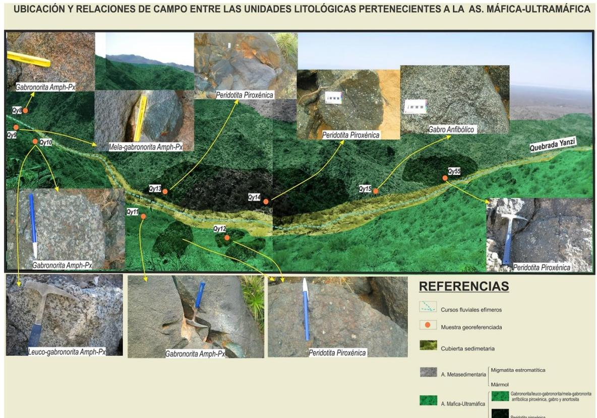
Fig. 5-1.1: Asociación máfica-ultramáfica en una sección de la Qda. Yanzi en la que se observa esquemáticamente los afloramientos ultramáficos peridotíticos en un entorno dominado por rocas gábricas. Los contactos entre ambas litologías son simplemente gráficos y estimativos dado que en campo resultan en pasajes transicionales difíciles de precisar. Escalas: nivel 12 cm, regla 8 cm, piqueta 30 cm, lapicera 15 cm.
