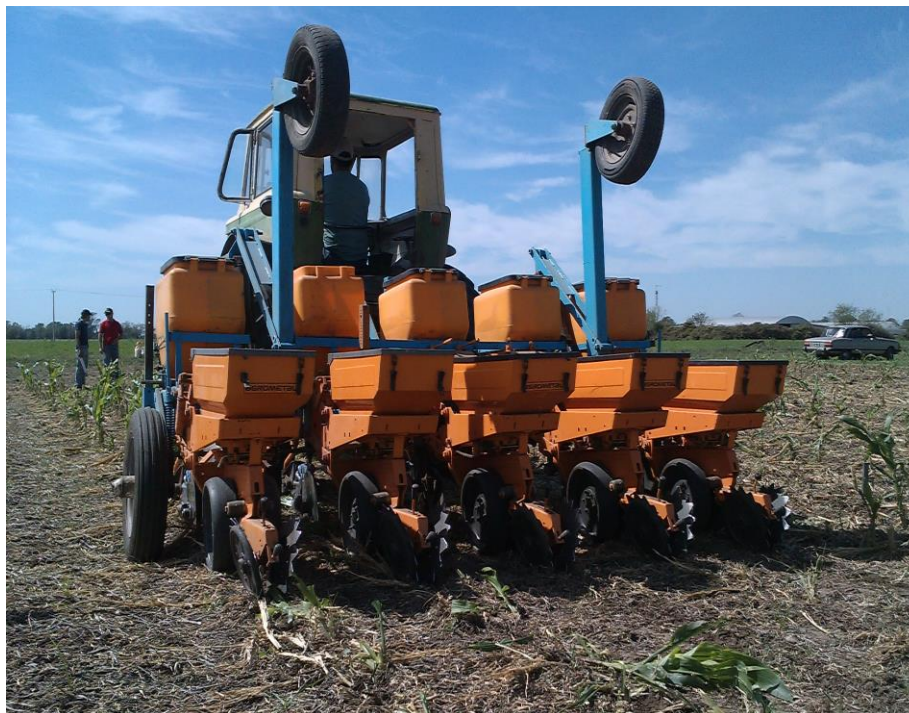
Figura 4: Sembradora de siembra directa provista de dosificador de semillas mecánico de placa horizontal tipo Agrometal utilizada en el ensayo.
