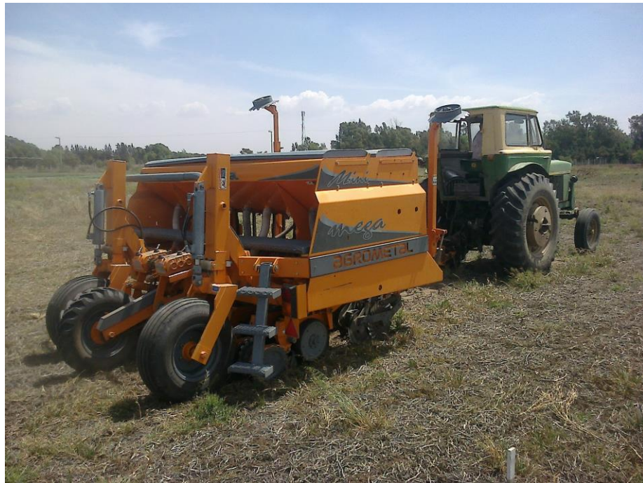
Figura 3: Sembradora de siembra directa provista de dosificador de semillas neumático tipo Agrometal utilizada en el ensayo.
