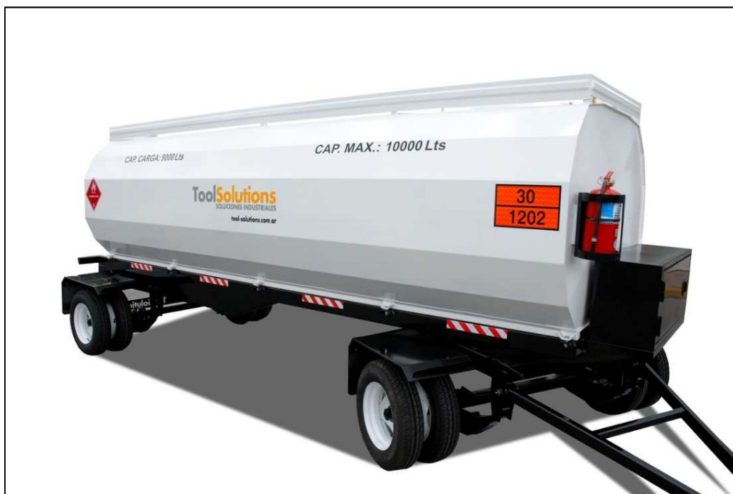
Figura 24: Cisterna de combustible, capacidad 10.000 l.
