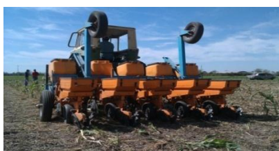
Figura 5: Sembradora provista de dosificador mecánico con placa en posición horizontal.
