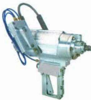
Figura N° 8.- Pistola neumática penetrante
