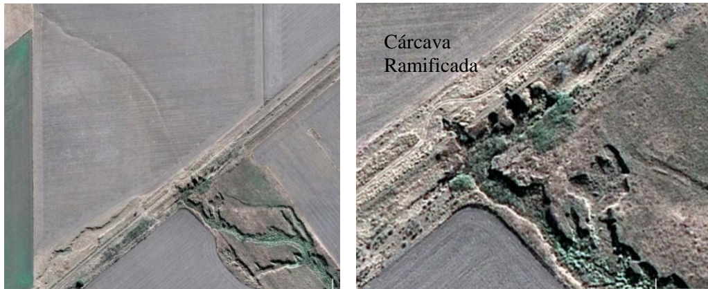
Figura 1: Ramificación de la cárcava en Cuenca Arroyo Los Jagüeles. (Imagen extraída de Google Earth).
