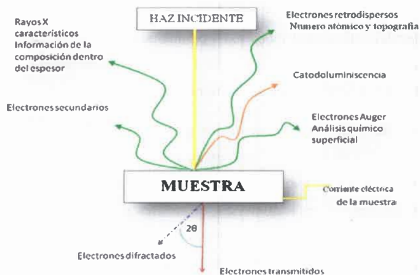
Figura 12. Esquema general del efecto del haz de electrones sobre una muestra que dan lugar a los tipos de microscopía electrónica más importantes.
