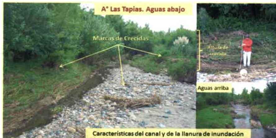
Figura 7.12. Características de la sección de aforo y marcas de crecida. A° Las Tapias (KA18).
