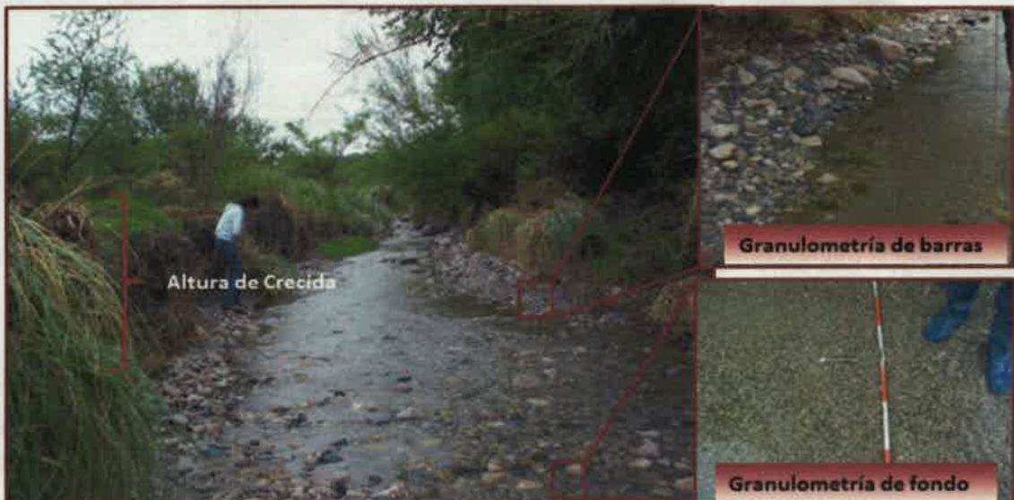
Figura 7.10. Marcas de crecidas y detalles de las granulometrías de los depósitos de barra y canal A° Los Homillos (KA7).
