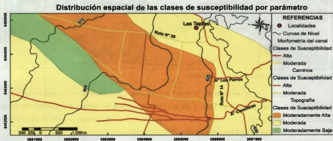
Figura 11.21. Mapa de distribución espacial de las clases de susceptibilidad por parámetro. El sector en blanco corresponde a otra cuenca es por ello que queda fuera del análisis.
