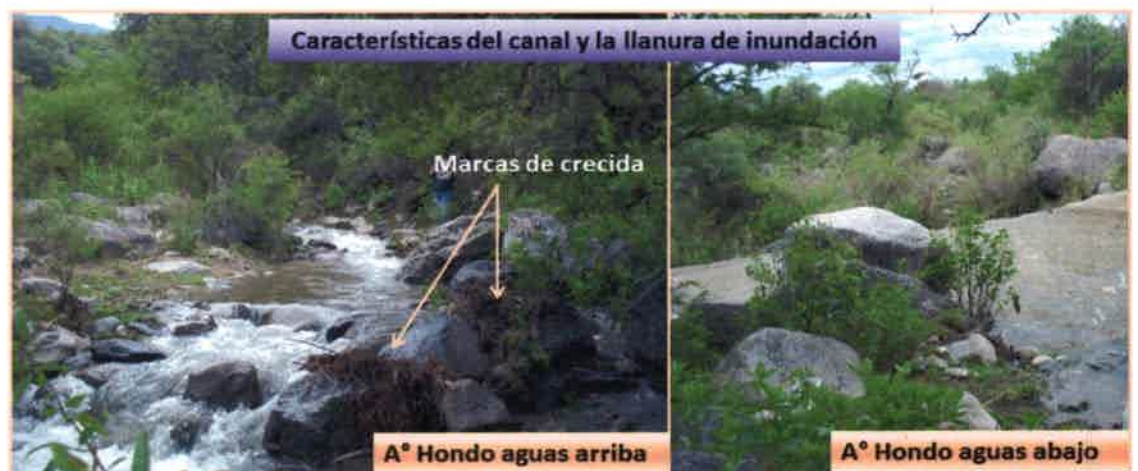
Figura 7.8. Marcas de crecidas y características de la sección de aforo. A° Hondo (KA3)
