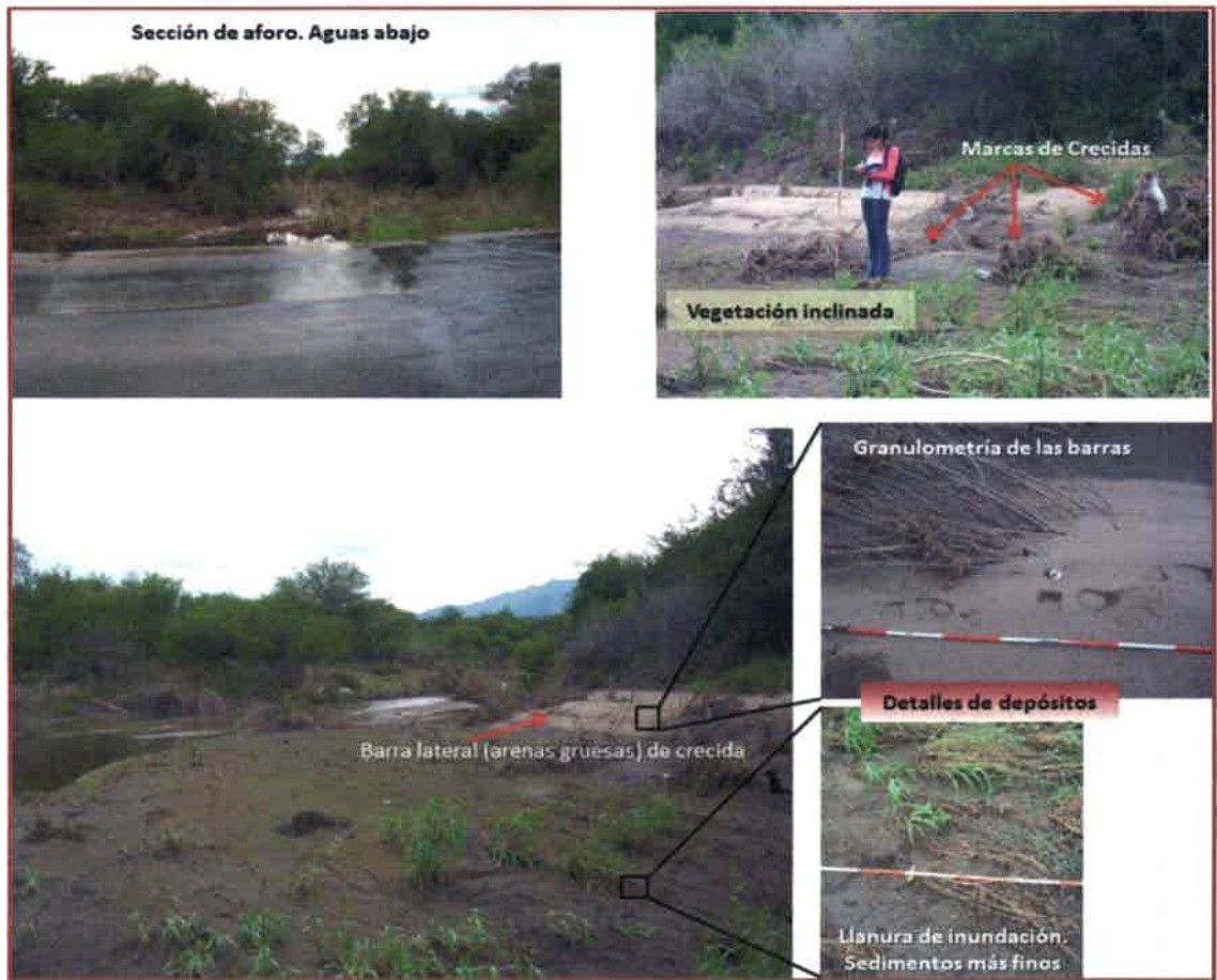
Figura 7.7. Sección transversal del A° Chuchiras (KA1) aguas arriba ruta N°14. Detalle de marcas de crecidas y depósitos en distintas posiciones del canal.
