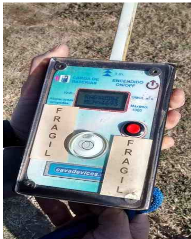
Imagen 11. Barra de radiación BAR-RAD 100 con sensores LICOR. U.N.R.C. Río Cuarto.
