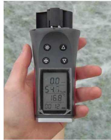
Imagen 14. Termo- higo anemómetro digital marca Skywatch (Atmos) para la medición de H° relativa del aire. U.N.R.C. Río Cuarto.
