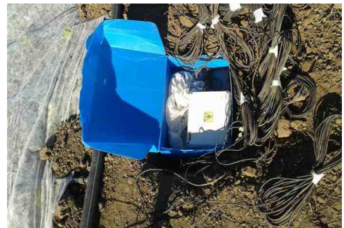
Imagen 12 Equipo Data Loggers para la medición de la temperatura del aire. U.N.R.C. Río Cuarto.
