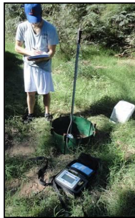
Foto 11. Sonda Diviner 2000 en posición de lectura.
