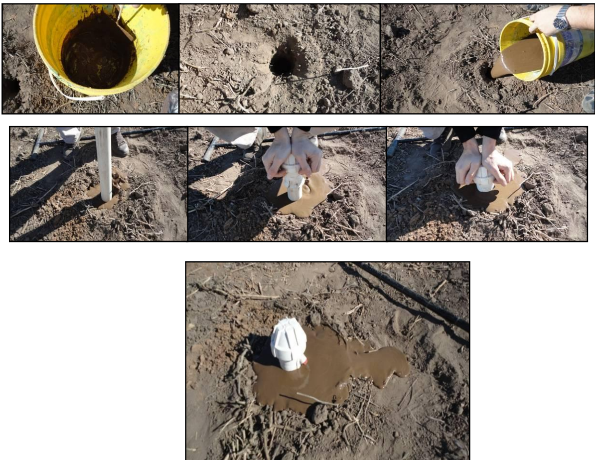
Foto 5. Imágenes en secuencia para la instalación de un tubo de acceso.
