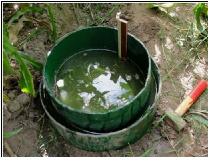
Figura 8: Ensayos de infiltración con doble anillo, UNRC, Río Cuarto, Córdoba.
