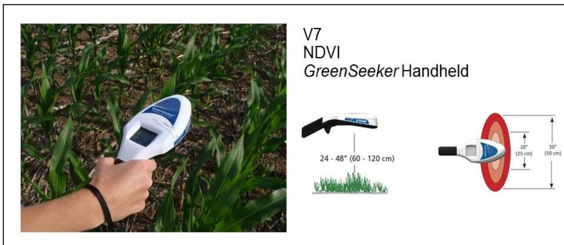
Figura N°10 Imagen ilustrativa del instrumento GreenSeeker y su funcionamiento.
