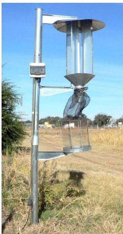
Figura 7: Trampa de luz utilizada para la captura de adultos de R. nu .
