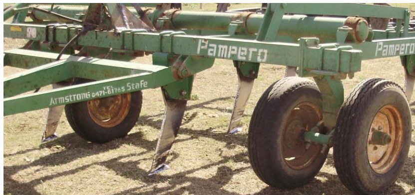
Figura 3: Imagen del equipo descompactador y vista lateral de la reja descompactadora.
