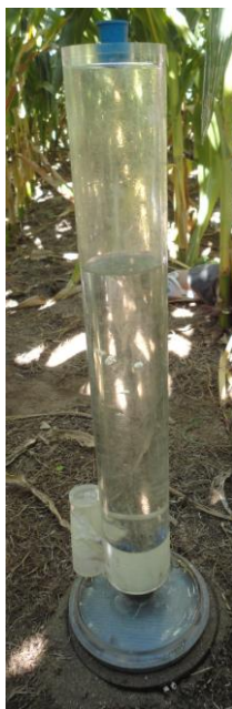
Figura 5: Imagen del permeámetro de disco en funcionamiento.
