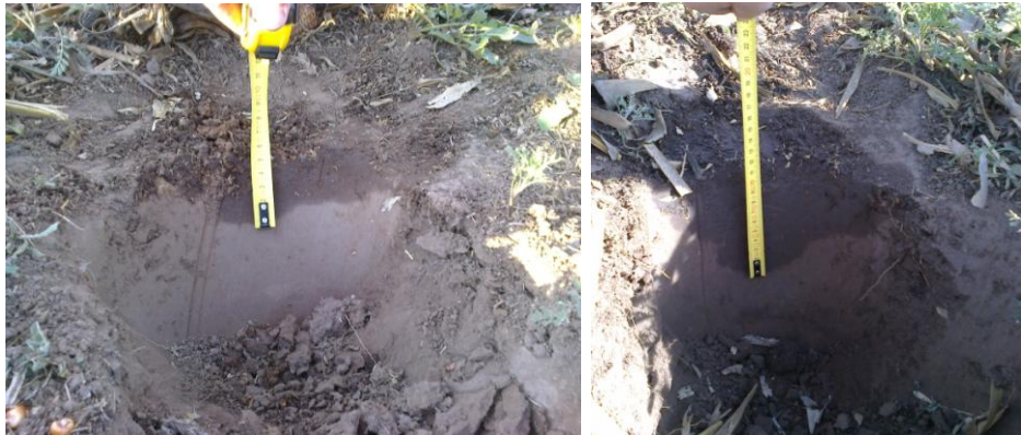
Figura 10: Perfil de humedecimiento. Imagen izquierda SDh, imagen derecha SDfh.
