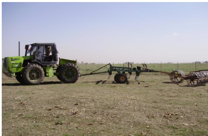
Figura 2: Imagen del equipo tractor/descompactador/rolo, en el sitio experimental.
