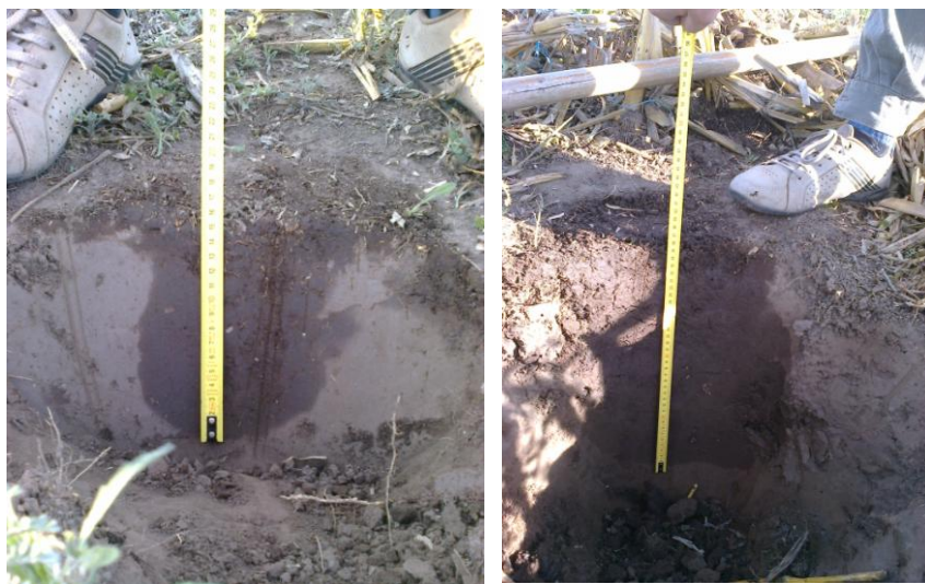
Figura 11: Perfil de humedecimiento. Imagen izquierda SDdh, imagen derecha SDdfh.
