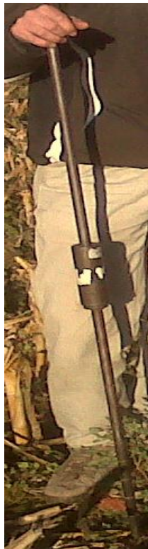
Figura 6: Imagen del penetrómetro de impacto.
