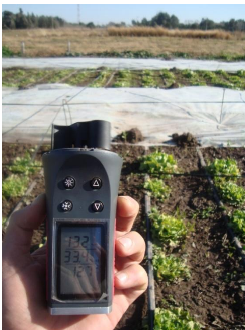
Figura 8. Termohigroanemómetro, para la medición de la temperatura y la humedad del aire.
