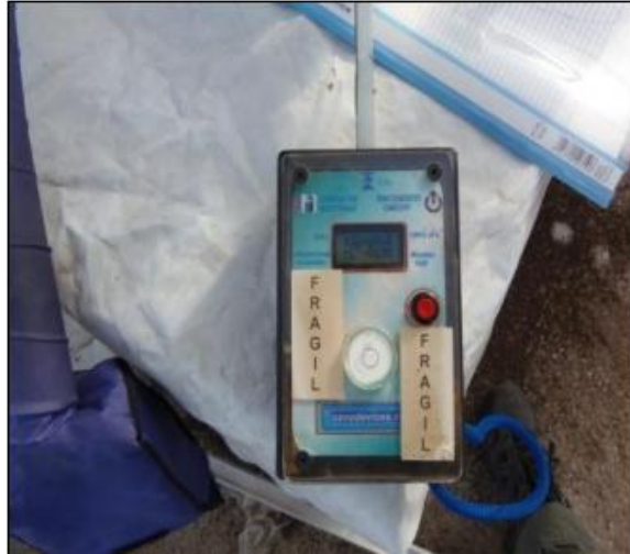
Figura 6. Equipo de medición de radiación fotosintéticamente activa.
