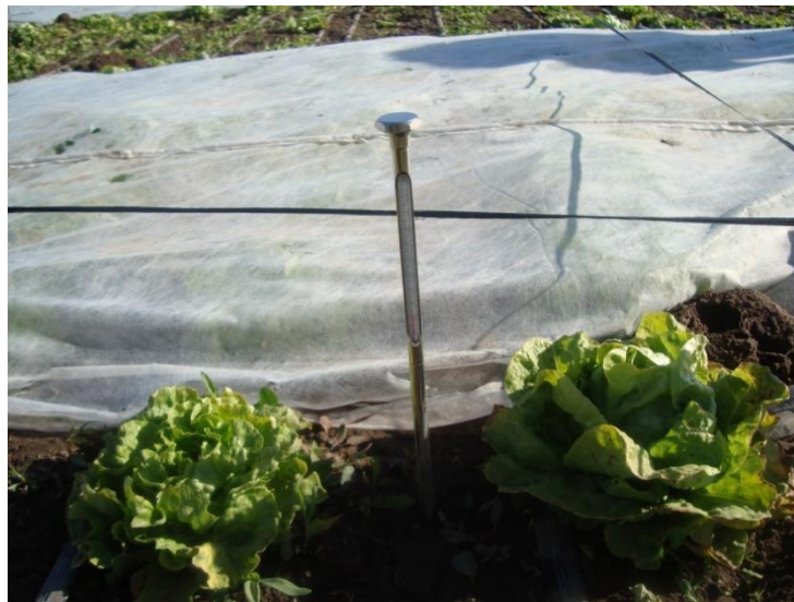
Figura 7. Geotermómetro, para la medición de la temperatura de suelo.
