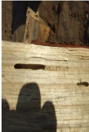
Figura 7: Galerías producidas por Arhopalus spp, observándose en las mismas el aserrín compactado.
