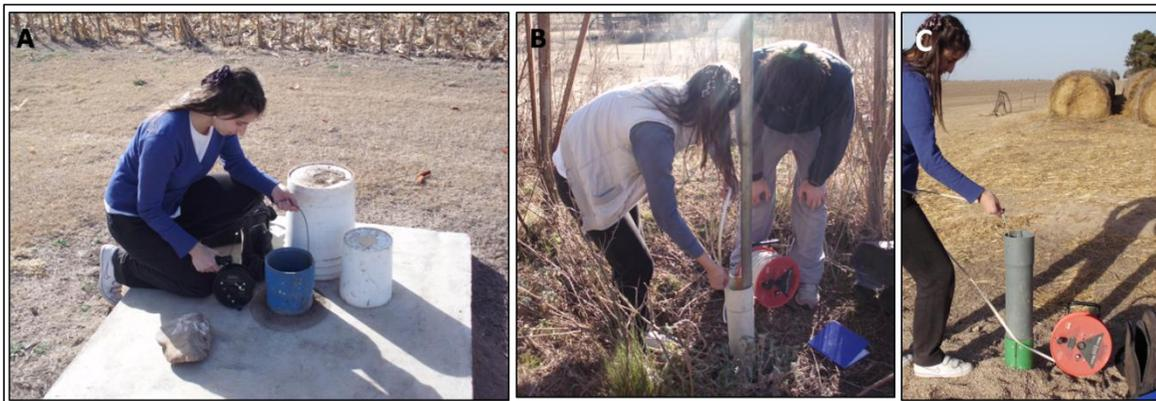
**Figura 6.26:** A- Medición de nivel freático con sonda de señal lumínica y sonora de 30 m de longitud. B y C- Medición de nivel freático con sonda de señal lumínica y sonora de 100 m de longitud.
