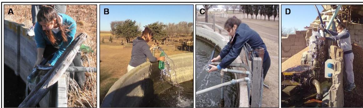
**Figura 7.2:** A, C y D- medición in-situ de parámetros físico-químicos. B- Extracción de muestra para posterior tratamiento en laboratorio
