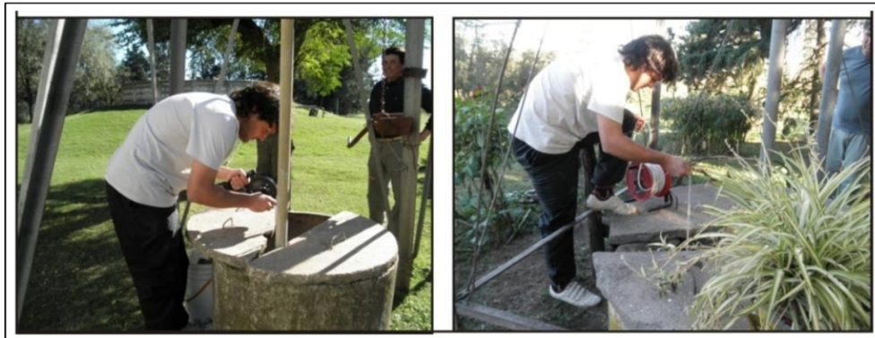
Figura 6.16: Medición de niveles freáticos estáticos. Cuenca arroyo Mosuc mayú, 2013.
