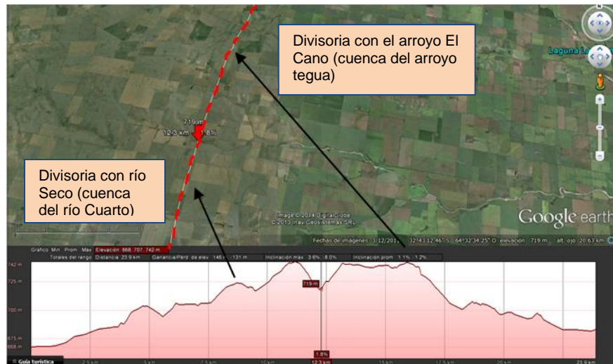
Figura 3.8: Imagen Google Earth con perfil de elevación mostrando bloque elevado y divisorias de cuenca.
