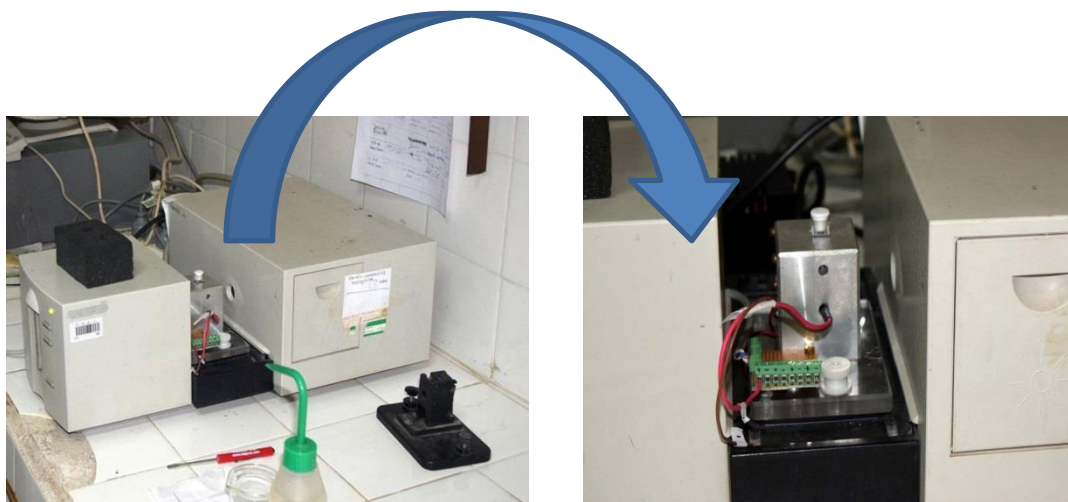
Figura 4. Imágenes del portacelda diseñado para de consumo de sustrato.
