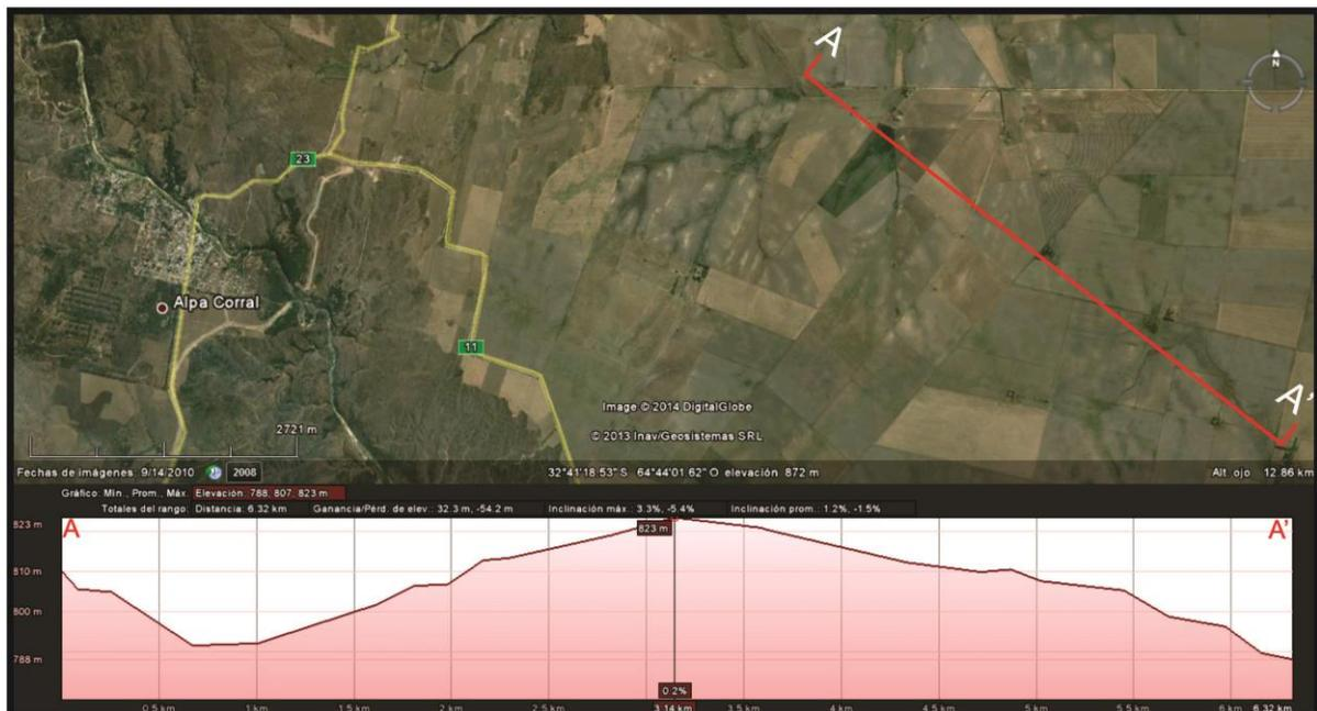
**Figura IV.5.:** Perfil topográfico atravesando la subunidad geomorfológica "Bloque estructural elevado", en el sector SO de la cuenca de estudio. Imagen satelital obtenida del Software Google Earth.
