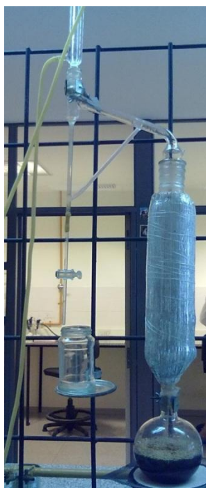
Figura 7: Equipo de hidrodestilación para obtención de aceites esenciales.
