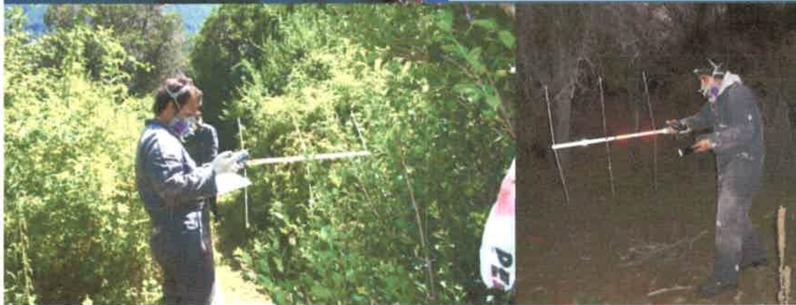
Figura 31: Elementos básicos utilizados durante la radio-telemetría: Receptor RX-TLNX con un rango de recepción de 148-174 MHz y 216-222 MHz, de alta sensibilidad -148 a -150 dBm. Antena Yagi de tres elementos con direccionalidad de detección.
