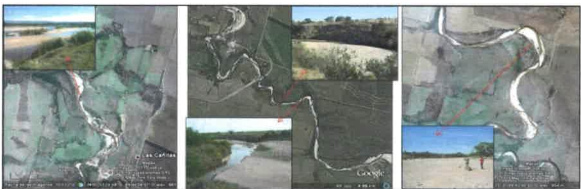
Figura III.7.38. Río Las Cañitas, a la izquierda y a la derecha dos fotografías de secciones transversales en los tramos de diseño de moderada sinuosidad, y en el centro dos fotografías de secciones en el tramo de diseño recto.
