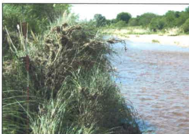
Figura IV.4.18. Marca de crecida en sección 5054.5*, evento previo a octubre 2012, caudal estimado 199,6 m 3 /s.
