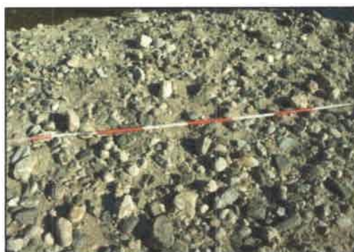
Figura III.7.57. Barra de crecida analizada en la Figura III.7.56 (jalón segmentado cada 20 cm).
