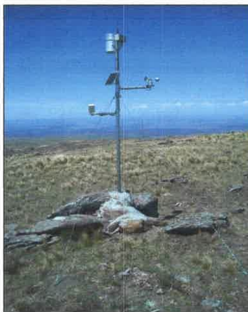
Figura III.3.3. Estación meteorológica automática La Cumbre instalada en la cuenca alta del río Las Cañitas.
