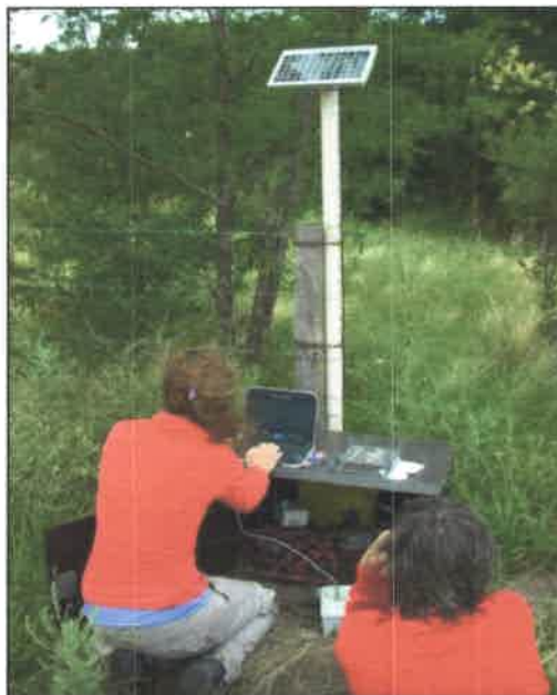
Figura III.5.25. Bajada de datos desde caja registradora del limnómetro.
