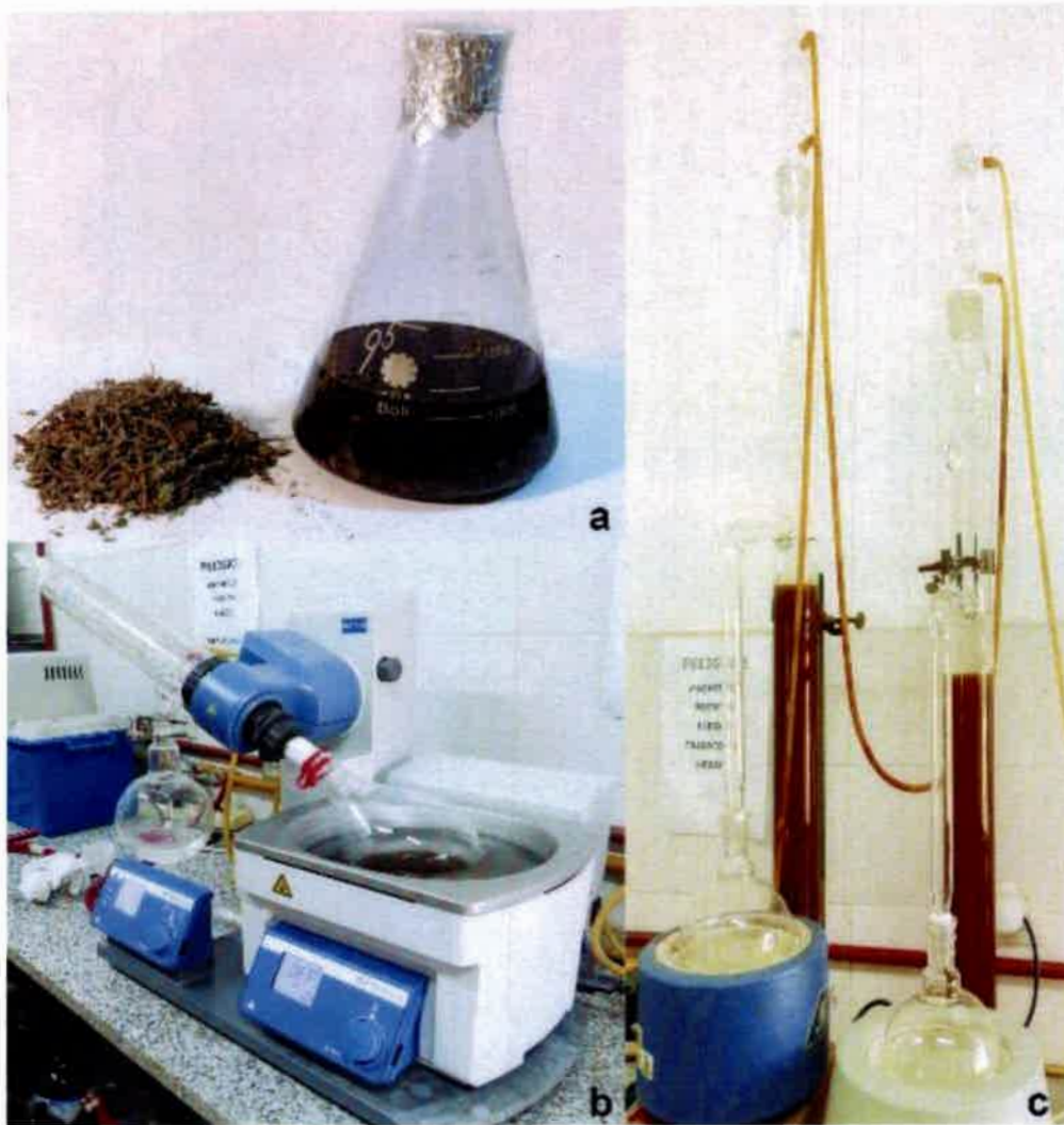
Fig. 6- Obtención de extractos de “peperina”. (a) Macerado etanol/ agua (1:1). (b) Concentración del extracto hidroalcoholico, para obtener el EA. (c) Extracción líquido-líquido con solventes de polaridad creciente, para obtener los diferentes extractos.
