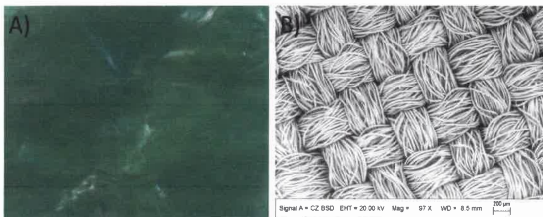
Figura 35: A) PANI sobre polietileno. B) Imagen SEM de PANI sobre tela comercial.
