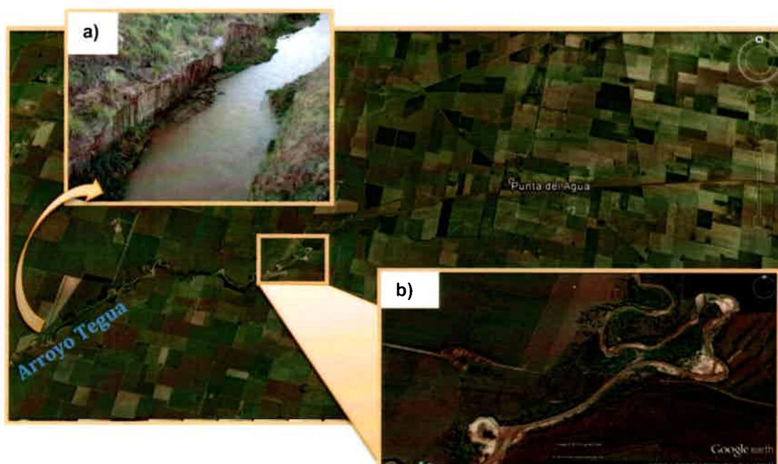
Figura 4.10. a) Fotografía que muestra la profundidad de las barrancas lo que denota la fuerte incidencia vertical que posee este arroyo en su traza final. b) Imagen que muestra la traza meandriforme del arroyo Tegua hasta la falla Reducción-Del Chañar y posteriormente su paso a rectilínea (imagen de Google Earth, 2013).
