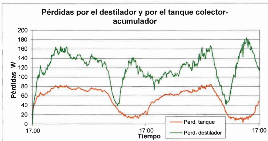
Figura 5.9: Comparación de pérdidas por el tanque colector-acumulador y por el destilador obtenidas experimentalmente.
