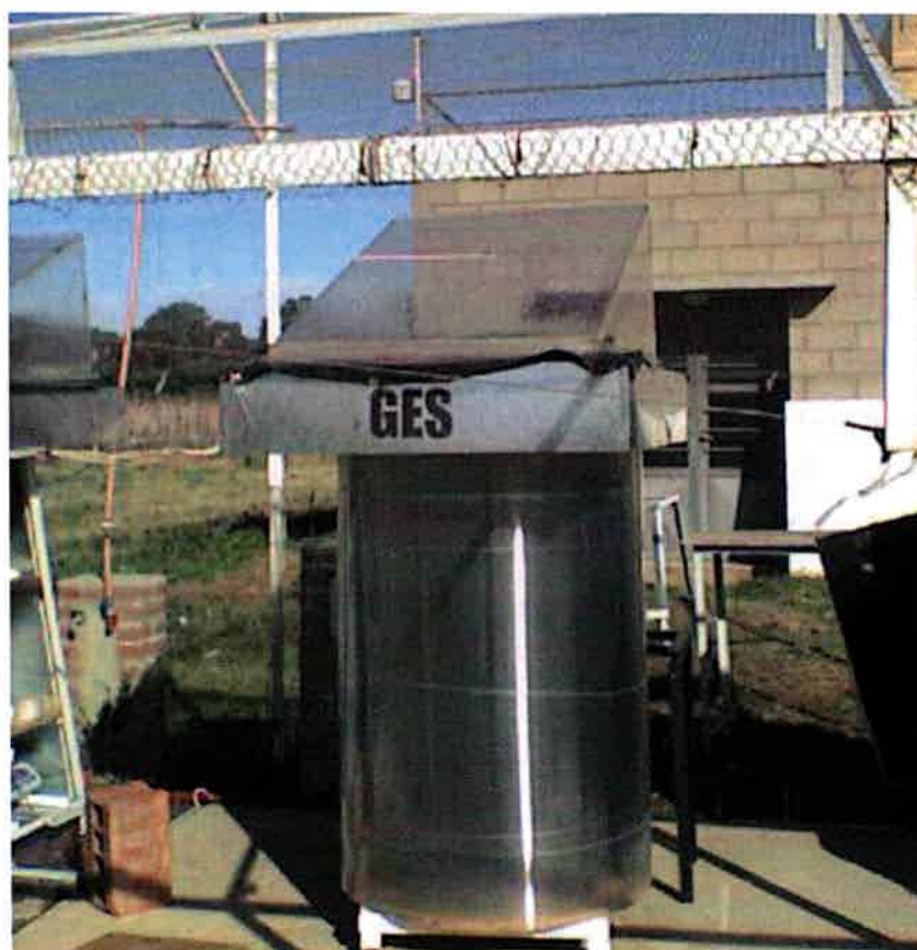
Figura 1.1. Vista del Destilador Solar Colector Acumulador usado en nuestra experiencia
