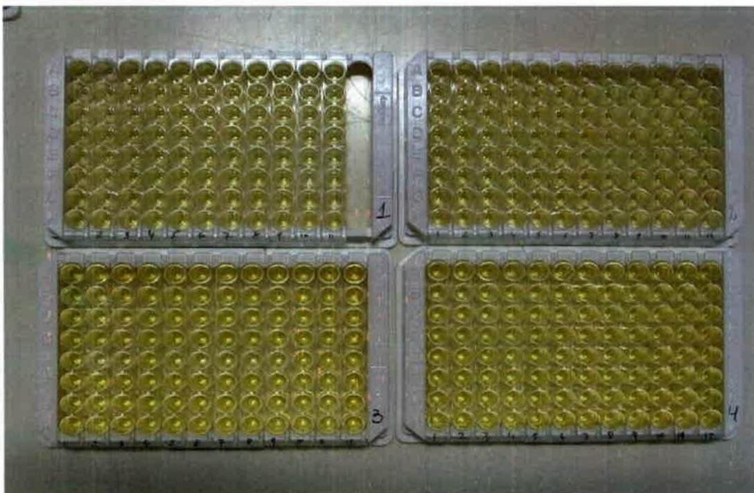
Finalmente, se realizó la medición de los valores de densidad óptica (DO) de las muestras de suero y controles por medio del fotómetro con filtros de 450 nm de marca Labsystem. Para la interpretación de los resultados suministrados por el lector, se empleó la siguiente fórmula:
