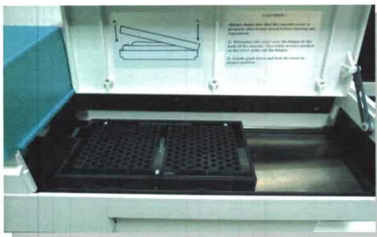
**Figura V.1.** Espectrofotómetro Bioscreen C, utilizado para el ensayo.
