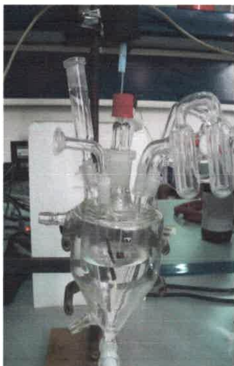
Figura 14. Fotografía de una celda de tres electrodos acopladas al Espectrofotómetro de masas
