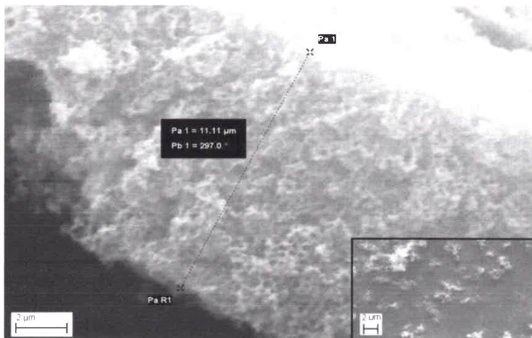
Figura 72. Principal. Imagen SEM de una sección de la película de HPC-400-Pt/Ru. Inseto, pequeñas estructuras compuestas de fragmentos de carbón observadas en la región periférica del electrodo
