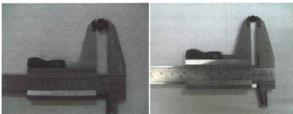
Figura 19. Imágenes del carbón obtenido sin la utilización del molde. Imagen de la Izq. resina antes de la carbonización; Der. Carbón obtenido después de la carbonización.
