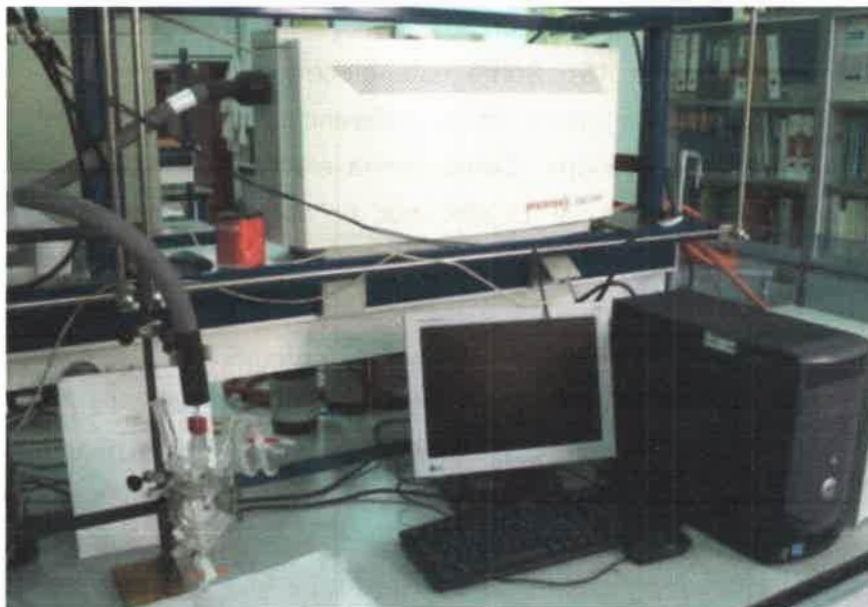
Figura 12. Espectrómetro de masas acoplado a la celda electroquímica, para la caracterización superficial de los catalizadores sintetizados. Equipo utilizado en las estancias en la Universidad de La Laguna
