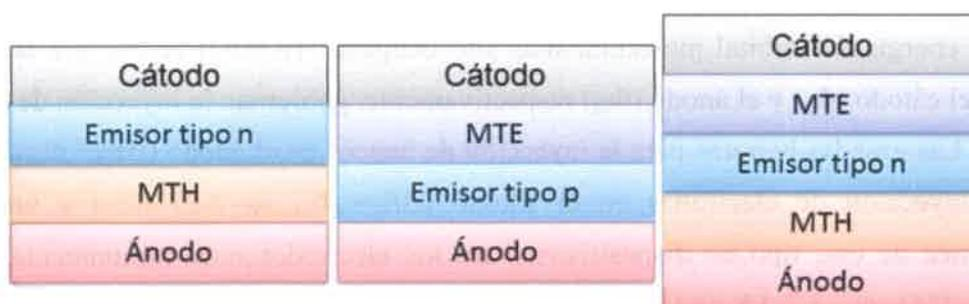
**Figura 7.** Diferentes OLEDs de configuración de multicapa.
