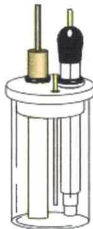
Figura 3.3. Esquema de una celda de un compartimiento marca BAS.
