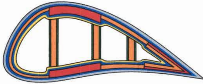
Figura 3-4: Esquema de laminación de una pala de aerogenerador (sección típica).
