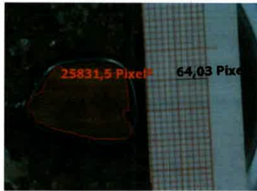
Fig.10: determinación de la superficie de corte del HSD.
