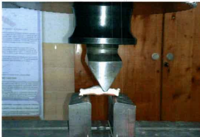
Fig.9: prueba de resistencia a la flexión del HSD.
