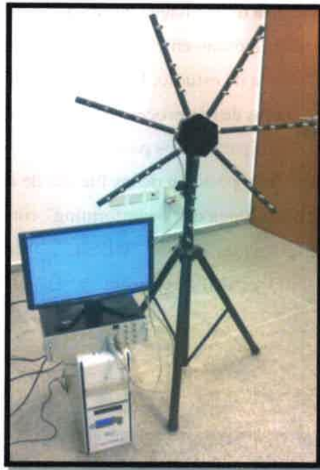
Figura A-9: Sistema de adquisición y antena de micrófonos (hardware).
