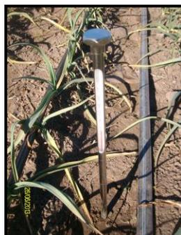
Figura 9. Lectura de temperatura de suelo mediante geotermómetro. Planta Piloto UNRC. Río Cuarto. Córdoba
