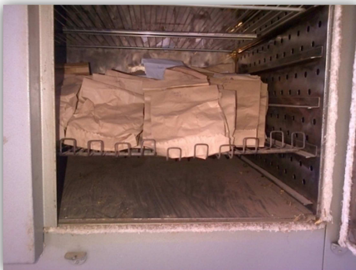
Fig. 4. Panojas embolsadas, en estufa, listas para proceder al secado.
