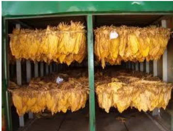
**Imagen 21:** Frente de una estufa bulk-curing, cargada con peines al final del proceso de curado.
