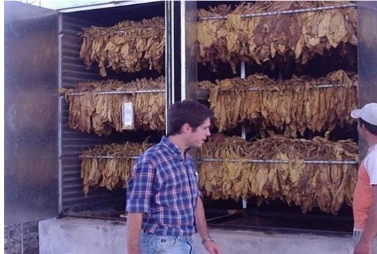
**Imagen 10:** Estufa Bulk-Curing lista para descargar.
