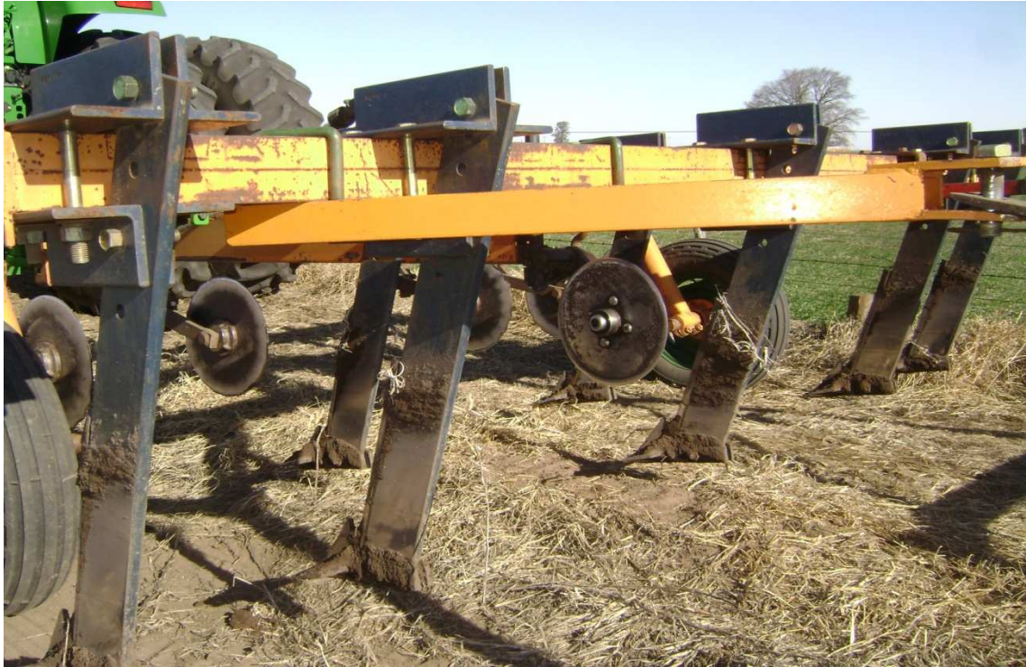
Figura 9: Vista posterior del implemento de armado artesanal, timones Agro-flex con rejas aladas de 18 cm montados sobre bastidor de cincel Chiappano.
