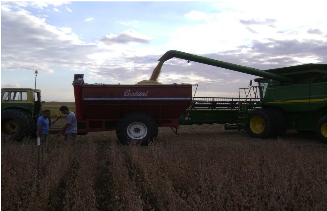
Figura 10: Determinación de rendimiento con balanza de la tolva autodescargable en la cabecera del lote con el cultivo de soja.
