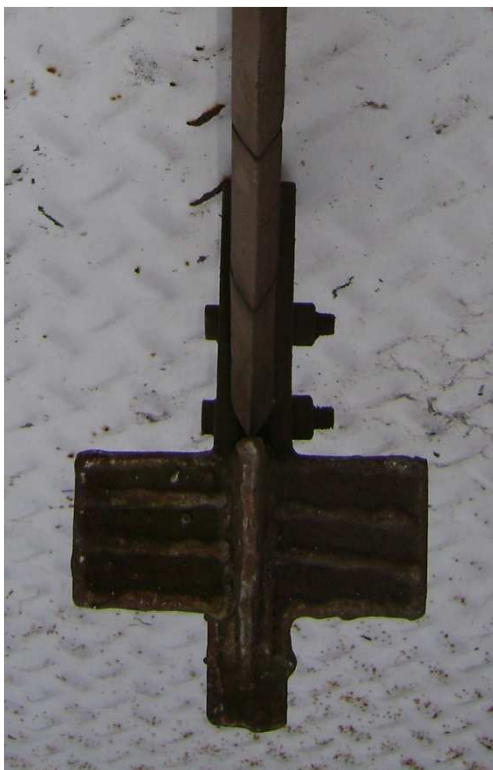
Figura 2: Vista frontal del timón y reja utilizado.
