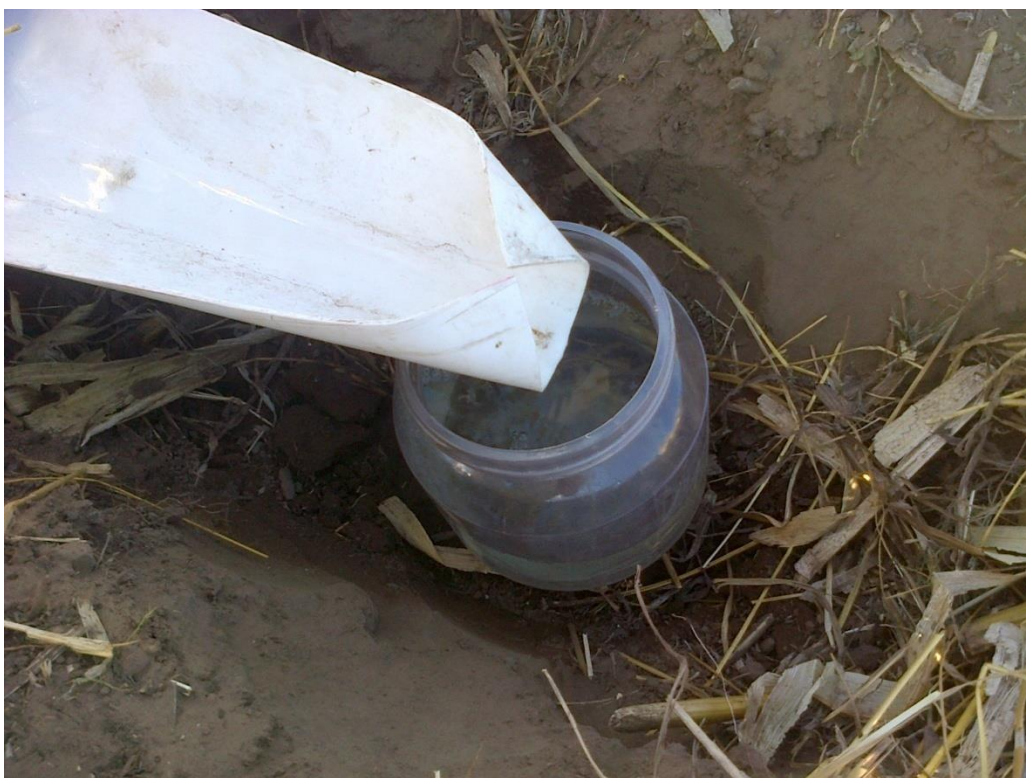
Foto 3. Detalle del vertedero del simulador de lluvias y del recipiente colector de la lámina escurrida (mm), colocado aguas abajo.
