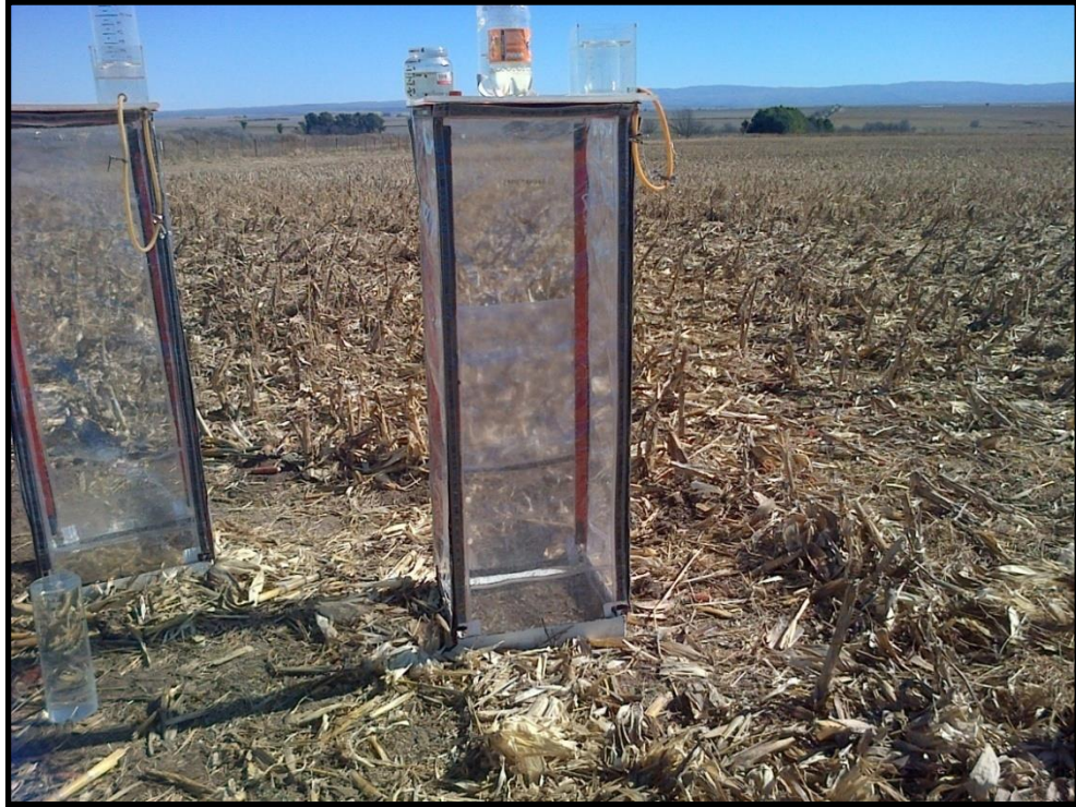
Foto 2. Vista del lote donde se realizó el presente estudio, con los simuladores de lluvia representando a los niveles con y sin cobertura superficial de rastrojos.
