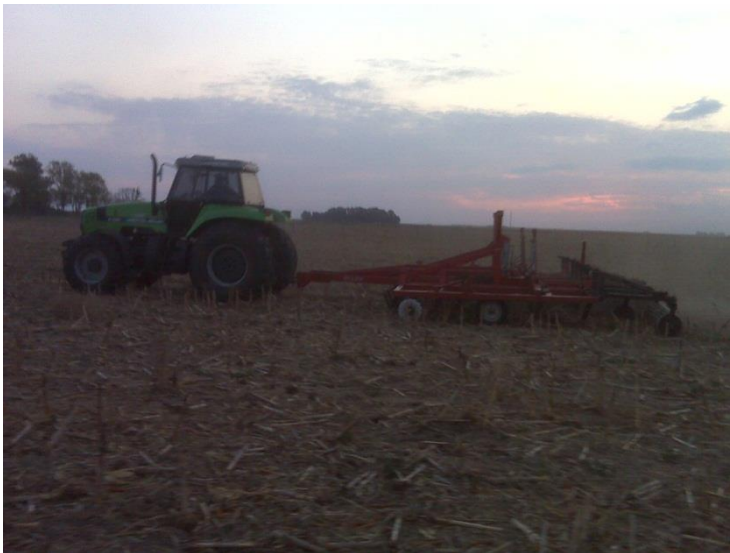
Foto 9. Momento en el cual se realizaba el labor de PARATILL a una profundidad de 30 cm.
