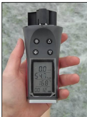
Figura 3. Termohigroanemómetro, para la medición de la temperatura y humedad del aire.
