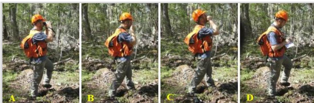
**Figura 8: Toma de altura dominante en parcelas de relevamiento. Esta alternativa emplea un distanciómetro laser (A) para la toma de distancia al árbol identificado y a posterior se mide el ángulo inferior y superior (B y C) con clinómetro de Suunto (en porcentaje). Por último, se registra en la planilla los valores de distancia en metros y ángulos en porcentaje para calcular las alturas en gabinete.**
